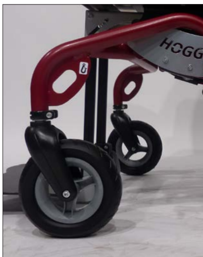
Upevňovací body, přední, podle ISO 7176-19
